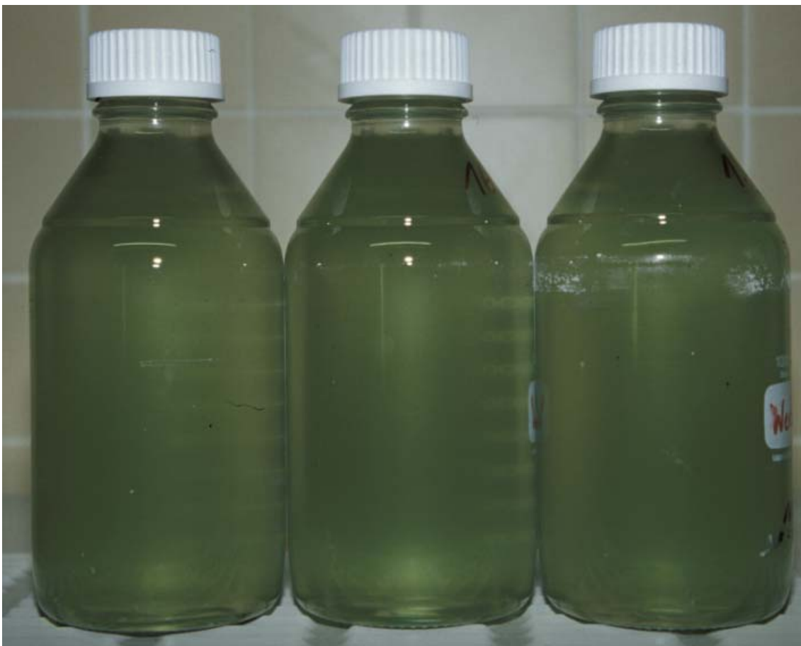
Abb. 2.3 – Borosilikatglasflaschen als Rolltanks, hier mit frisch eingefüllter Microcystis -Suspension.
