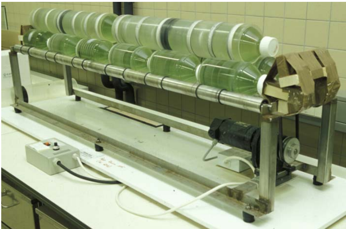
Abb. 2.4 – Gestell mit 18 aufgelegten Rolltanks. Diese Maximalbeladung wurde nur für kurze Zeit angewandt, da auftretende Scherkräfte zu einem schnellen Verschleiß der auf den Wellen befindlichen Gummiringe führten. In der Regel wurden 12 Tanks gleichzeitig verwendet.
